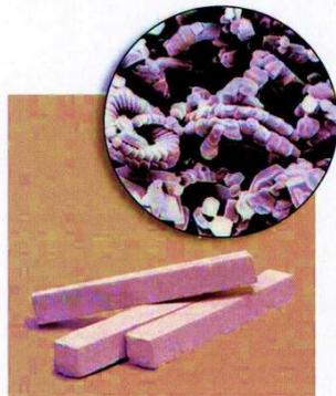
**Рис. 85.** Мел под сканирующим электронным микроскопом (увеличение в 6,5 тыс. раз)
