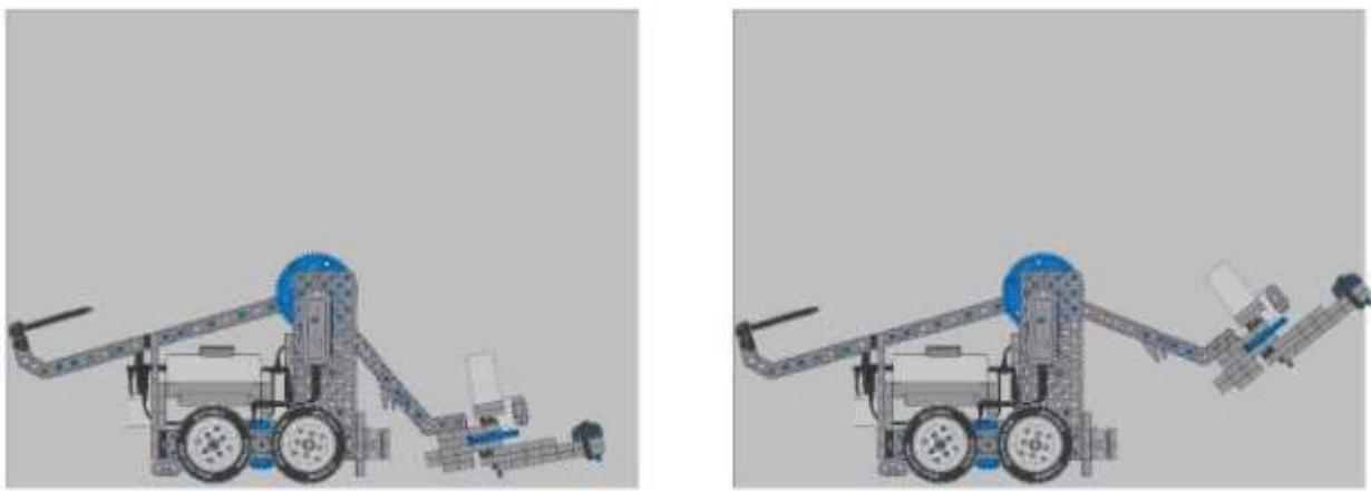
Рисунки 8, 9 – Робот, начинающий матч с правильными размерами, и второй робот с неправильными габаритами из-за поднятого хвата.
