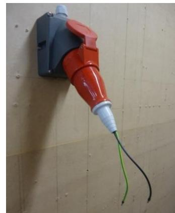
Подготовленные разъёмы соединяются с соответствующими разъёмами ЭУ. К полученным проводникам подключаются электроды мегомметра. Напряжение - 500В.
